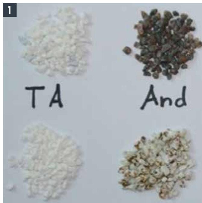
Bild 1 • Oben: Anlieferungszustand, unten: nach der Temperaturbehandlung (Aggregate der Größe 2,24–3 mm); Tabulartonerde: TA, Andalusit: And
